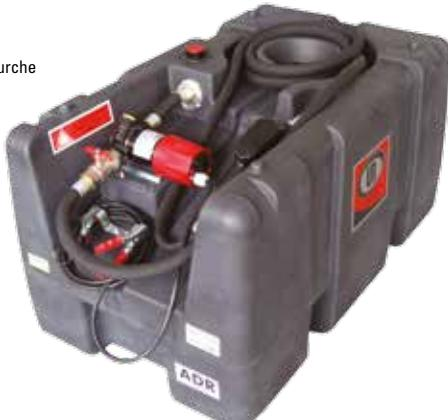
Cuve avec pompe 12 V, 34 L/min, 4 m de câble avec pinces batterie, 4 m de tuyau de refoulement, livrée avec un pistolet automatique, compteur, jauge
